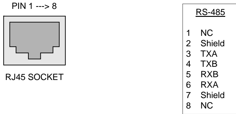
图三：RJ45 接口引脚定义
